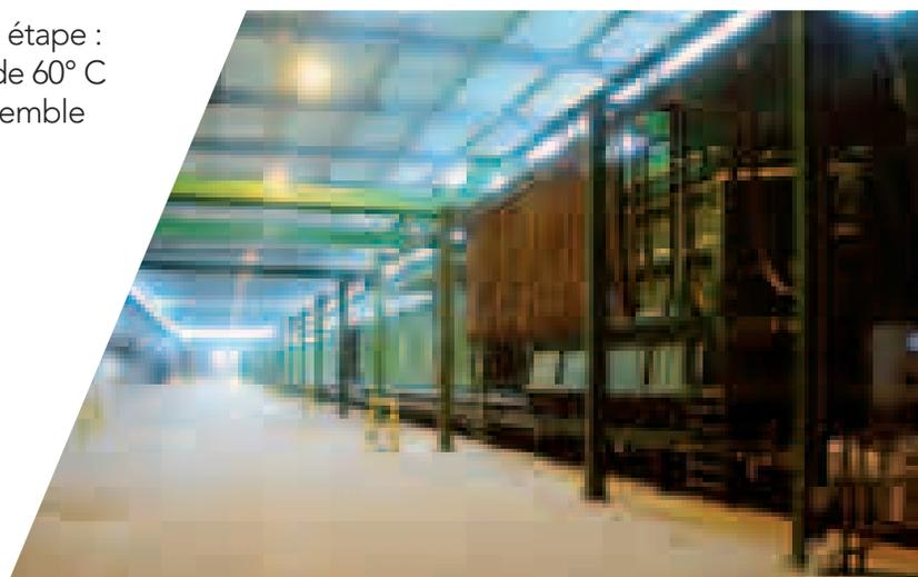
■ Tunnels de compostage avec système d'extraction
